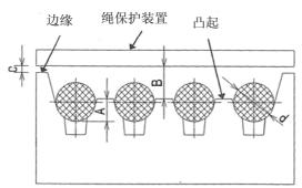
图 A. 5 绳脱槽保护装置的安装尺寸
