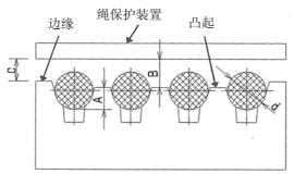
图 A. 4 绳脱槽保护装置的安装尺寸
