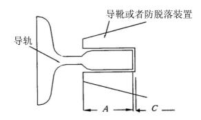
图A. 1 导靴或者防脱落装置与导轨之间的搭接尺寸
