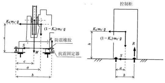
图A. 2 曳引机的设置示例
