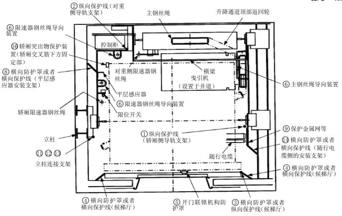
图 A. 8 无机房电梯的突出物保护措施设置示例
