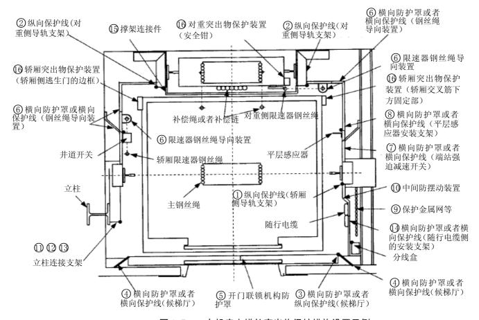
图 A. 7 有机房电梯的突出物保护措施设置示例
